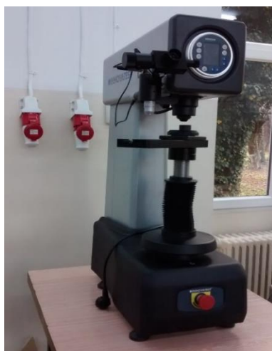
Figura 26. Laboratorul 2 - Durimetru Universal INNOVATEST VERZUS 700AS, Osciloscop Digital HMO 1002
