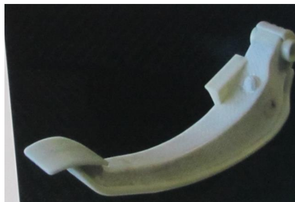
Fig. 8 Pedala realizată numai din material polimeric
