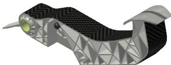
Fig. 7. Proiectarea pedalei. Fetele exterioare sunt realizate din țesături din fibre de sticlă sau de carbon înglobate într-o rășină termoplastă. Fetele laterale sunt realizate prin injecția ulterioară a materialului polimeric în matrită, după ce în prealabil plăcile de material compozit polimeric preformat au fost așezate în matrită.
