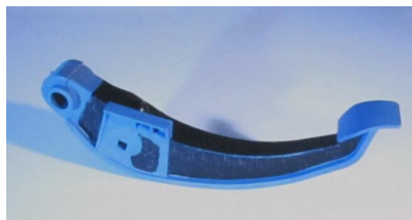
Figura 4. Pedala de ambreiaj cu ranforsari doar pe o singura parte
