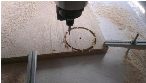
Fig. 3. Debitarea componentelor pe freza CNC
